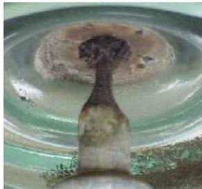
Degradação da ferragem. Possibilidade de ruptura da cadeia e queda do condutore
