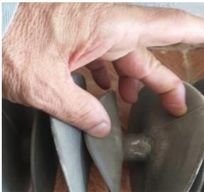
Degradação de isoladores. Possibilidade de arco e desligamentos não previstos
