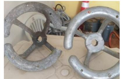
Degradação da ferragens e componentes metálicos submetidos ao efeito corona. Menor eficiência e possibilidade de descargas atmosféricas
